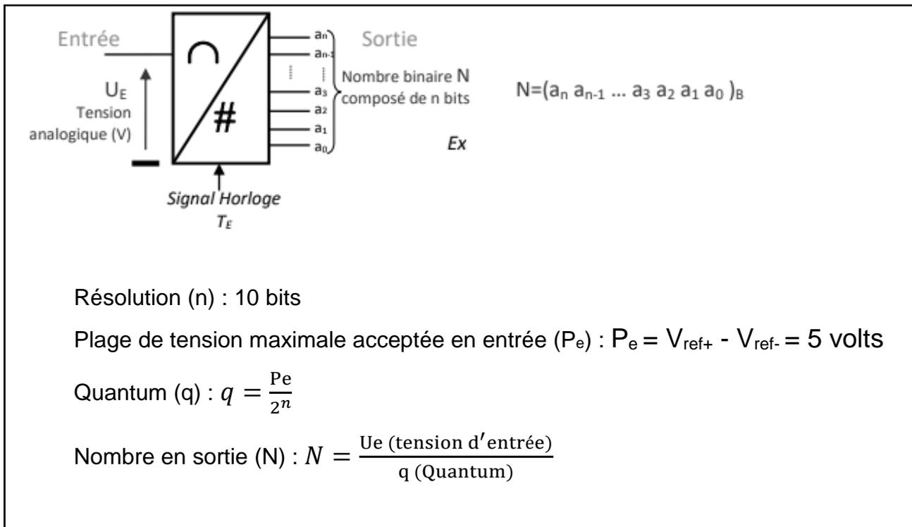
Fig. 4 – Caractéristiques du convertisseur analogique/numérique (CAN)
